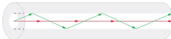
**Núcleo:** capa óptica central de la fibra desde donde se transmite la luz
